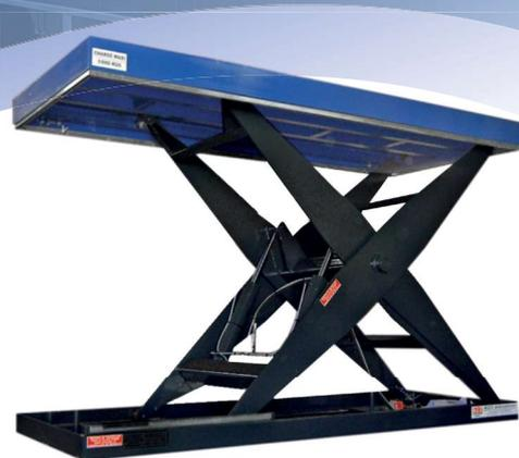
Nos tables sont certifiées CE. Elles répondent à la norme EN 1570-1 et à la directive machine n°2006/42/CE. Elles sont conçues pour l'élévation de charges et d'une façon générale, pour toute mise à niveau poste de travail (palettisation, conditionnement, ...). Elles soulèvent des charges uniformément réparties. Le plateau s'élève sous l'action de ciseaux poussés par un ou plusieurs vérins hydrauliques. La dimension des plateaux peut-être ajustée suivant vos besoins.
