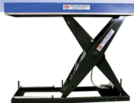
Nos tables sont certifiées CE. Elles répondent à la norme EN 1570-1 et à la directive machine n°2006/42/CE. Elles sont conçues pour l'élévation de charges et d'une façon générale, pour toute mise à niveau poste de travail (palettisation, conditionnement, ...). Elles soulèvent des charges uniformément réparties. Le plateau s'élève sous l'action de ciseaux poussés par un ou plusieurs vérins hydrauliques. La dimension des plateaux peut-être ajustée suivant vos besoins.
