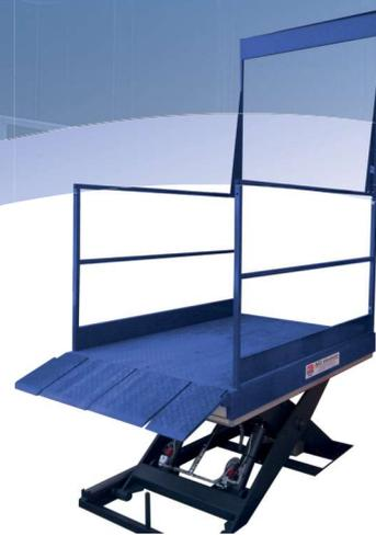
Nos tables sont certifiées CE. Elles répondent à la norme EN 1570-1 et à la directive «machines» n°2006/42/CE. Ces tables élévatrices sont spécialement conçues pour charger ou décharger tous types de véhicules. Elles permettent le transfert de charge en toute sécurité. Le plateau s'élève sous l'action de ciseaux poussés par des vérins hydrauliques. La dimension des plateaux peut être ajustée suivant vos besoins.
