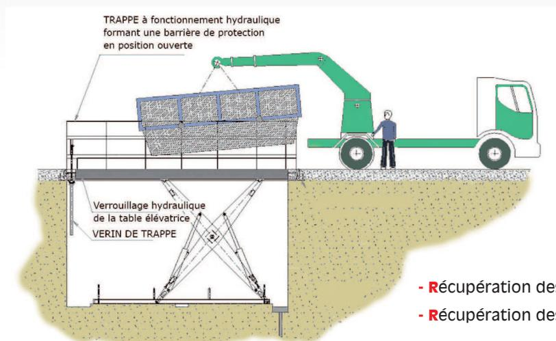
Une fois la table en position haute, un camion multibennes peut déposer ou enlever la benne comme si elle était posée à même le sol.
