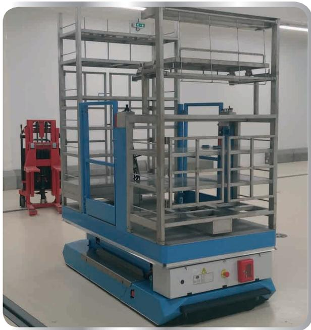
■ Les plateformes élévatrices automotrices de personnel se conduisent aussi bien à partir de la nacelle que de l'extérieur.
