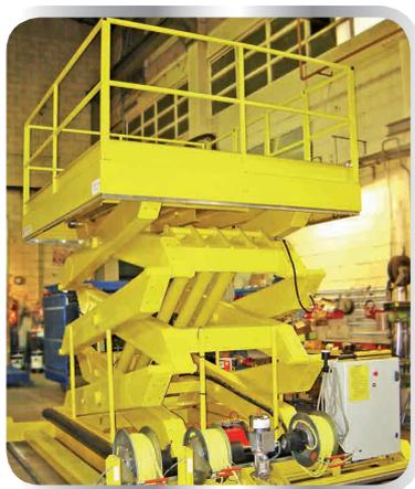
Plateforme mobile sur rails avec motorisation
