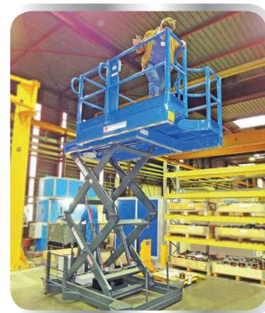
Plateforme mobile sur roues motorisées
